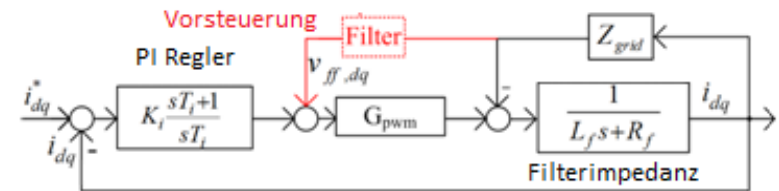
Vereinfachter Regelkreis für die Analyse
